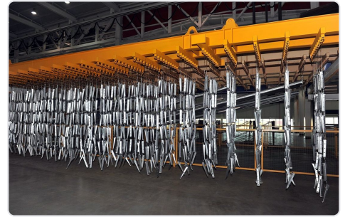
Sevk. Soğuyan ürünler kontrol ve paketleme için hattan alınır (P10).
