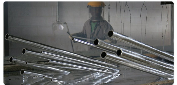
Parçalar tek tek askıya bağlanır ve birbirine değmeden daldırılır. Izgarada gözlerin açık olması çinkonun akmasını kolaylaştırır.
