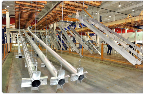
07 — Soğutma. Parçalar askıda, birbirine değmeden soğutulur; temas noktası kaplamada iz bırakır.
