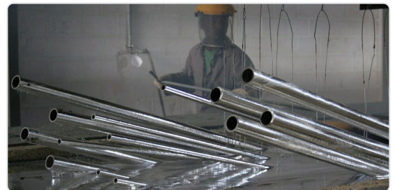
Die Teile werden einzeln aufgehängt und ohne Berührung getaucht. Die offenen Maschen des Rostes erleichtern den Zinkablauf.
