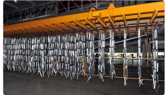
Verzinkte Produkte werden nach dem Abkühlen von der Linie genommen; hier beginnen Endkontrolle und Verpackung.
