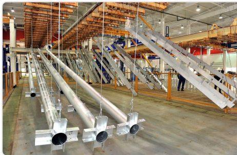
07 — Abkühlung. Die Teile kühlen am Gehänge ab, ohne sich zu berühren; Berührungsstellen hinterlassen Spuren in der Schicht.
